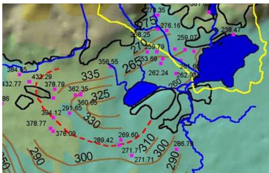
FIGURA 2.3. CARTA DELLE LINEE PIEZOMETRICHE (SCALA 1:50.000). LINEE MARRONE: LINEE PIEZOMETRICHE; LINEE GIALLE: BACINO IDROLOGICO DEL LAGO DI PUSIANO; LINEE NERE: ACQUIFERI NON SIGNIFICATIVI; LINEA TRATTEGGIATA ROSSA: BACINO IDROGEOLOGICO DEL LAGO DI ALSERIO; PUNTI ROSA: POZZI CENSITI.
